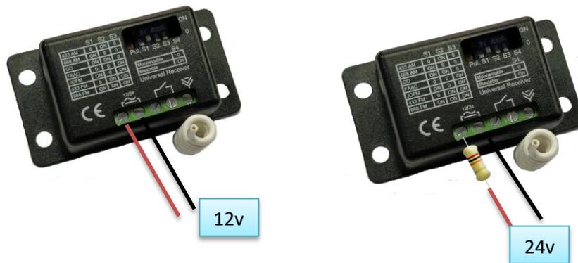
El receptor alimentado a 12v solo tiene que ir con los cables de alimentación positivo y negativo, si por el contrario hay que alimentarlo a 24v tendremos que poner la resistencia en serie conectando el positivo en el mismo.
