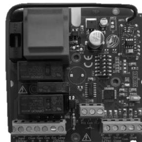
Unidad de control para puertas correderas y enrollables. Protección alimentación central y motores por fusible 230V 5A
