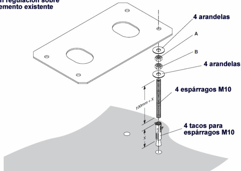
Fijación con tirafondos sobre vaciado de hormigón
