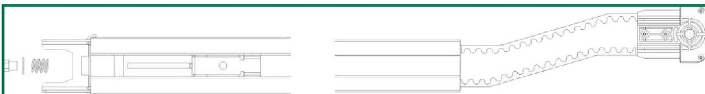
2. Cortar la guía desde el lado de la cabeza. **Nota:**  $L1 \leq L - 2000$  mm (L1: Longitud cortada, L: Longitud total)
