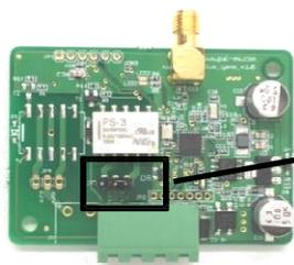
Modo relé puede ser cambiado con un jumper N.O / N.C
