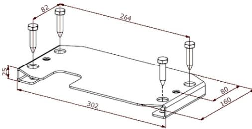
Procederemos en primer lugar en fijar la platina base al suelo o en el pilar, la podemos atornillar con tornillos de expansión o soldarla, y comprobaremos que esté nivelada. Tenemos que tener en cuenta la mano en que está situada la platina para la entrada correcta del cableado eléctrico (el cableado eléctrico entrará por la parte delantera izquierda).
