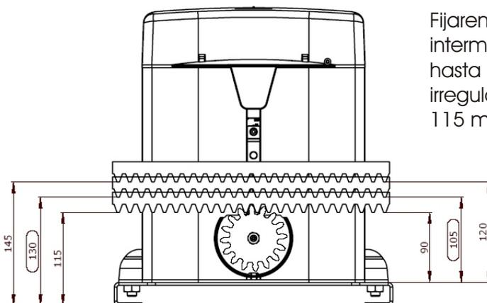
Fijaremos la cremallera (módulo 4) a la puerta en la medida intermedia de 130 mm desde la parte inferior de la platina hasta debajo del diente de la cremallera, si hay una pequeña irregularidad el piñón la absorberá entre la medidas de tolerancia, 115 mm. como mínimo y 145 mm. como máximo.
