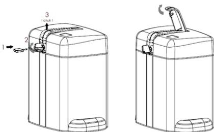
Insertaremos la llave en la cerradura girándola 45 grados, la maneta se alzará unos centímetros, seguidamente levantaremos la maneta hasta el punto máximo vertical.
