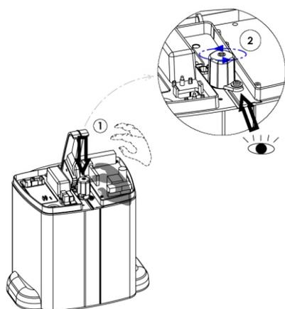
Para manipular o programar el automatismo sin la tapa, se tendrá que anular el dispositivo de desbloqueo rápido, el cual se encuentra debajo de la maneta desbloqueo (pieza cilíndrica de color amarillo), ya que con la maneta de desbloqueo levantada el sistema de seguridad bloquea el automatismo.
