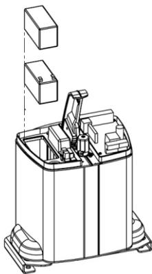
Podemos incorporar dos baterías, auto-recargables por la misma placa electrónica del automatismo, que nos asegura su funcionamiento en caso de un corte de suministro eléctrico. Depende de la puerta y del modelo de automatismo, éste puede realizar de 5 a 10 maniobras.
