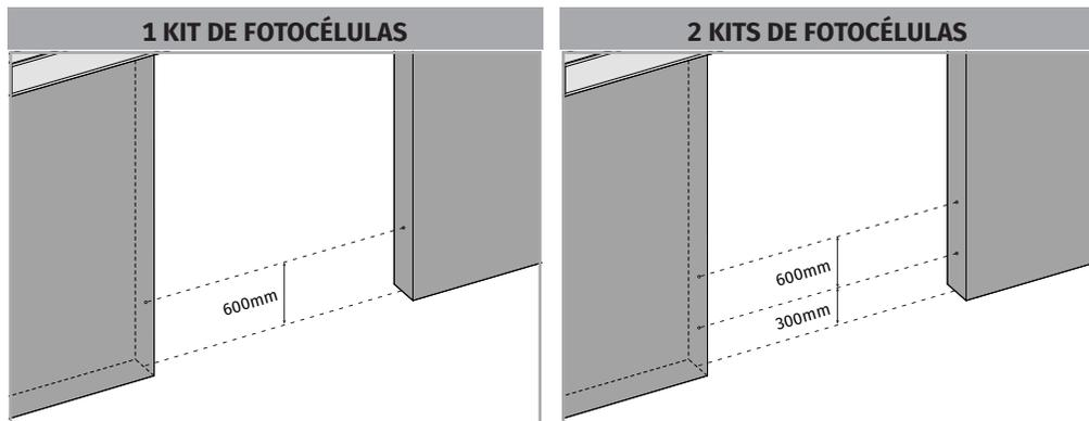
**01.** En los pilares, o chapas del hueco de luz, mida y marque para agujerear. Tenga atención que para tener un correcto funcionamiento, las fotocélulas deben de estar alineada horizontalmente.
