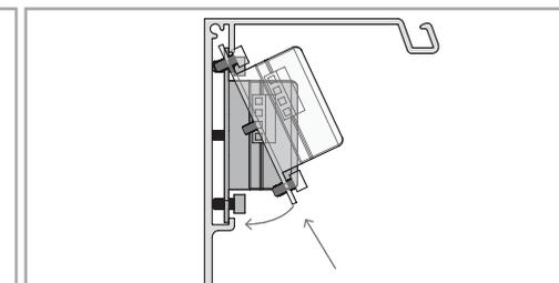
02. Coloque la chapa en la puerta, encajando primero la parte superior y a seguir la parte inferior de la chapa.
