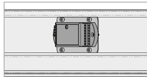
03. Apriete los tornillos que existen en las esquinas de la chapa, de manera que quede presionada la chapa del módulo con el perfil de la puerta.
