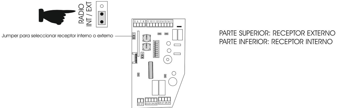
Para programar uno o varios emisores en el receptor integrado a la centralita ver página siguiente, y para programarlo en el externo, ver instrucciones del fabricante del receptor que utilizaremos.
