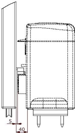
Colocar la platina base en una distancia de 40 mm de la puerta, procederemos a colocar la cremallera como figura el dibujo posterior, y seguidamente después de fijar la cremallera, atornillaremos el motor en la platina base y comprobaremos que entre el piñón y la puerta tenga una medida de 5-8 mm. aprox. como figura el dibujo.
