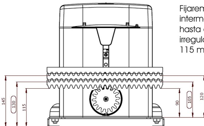
Fijaremos la cremallera (módulo 4) a la puerta en la medida intermedia de 130 mm desde la parte inferior de la platina hasta debajo del diente de la cremallera, si hay una pequeña irregularidad el piñón la absorberá entre la medidas de tolerancia, 115 mm. como mínimo y 145 mm. como máximo.
