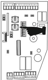
Para seleccionar la fuerza deseada para la puerta, se ajustara con el potenciómetro de regulación de fuerza en recorrido, tal como muestra el dibujo, le daremos fuerza girando la rueda en sentido horario y le reducimos fuerza girando en sentido anti horario, hasta verificar que la puerta esté con la fuerza permitida en normativas.
