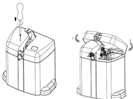
Abriremos la palanca del desbloqueo y destornillaremos el tornillo, tal como figura el dibujo, levantaremos la tapa por la parte frontal y desenchajaremos las grapas de la parte posterior. Para colocarla haremos la misma operación a la inversa.
