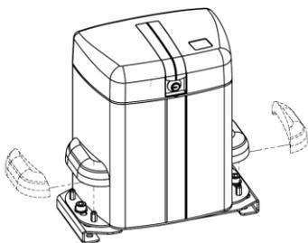
Una vez atornillado colocaremos la tapa embellecedora colocándola tal como indica el dibujo.
