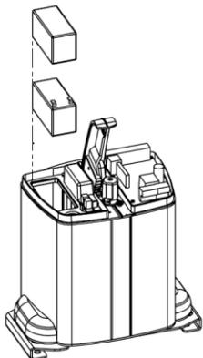
Podemos incorporar dos baterías, auto-recargables por la misma placa electrónica del automatismo, que nos asegura su funcionamiento en caso de un corte de suministro eléctrico. Depende de la puerta y del modelo de automatismo, éste puede realizar de 5 a 10 maniobras.
