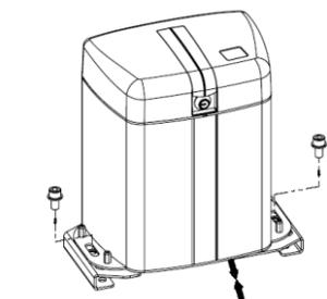
Colocaremos el automatismo sobre la placa base y atornillaremos regulando la distancia entre el piñón del automatismo y la puerta en 5-8 mm aprox.
