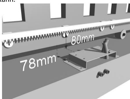
**POSIZIONAMENTO DEL MOTORIDUTTORE:** Posizionare il motoriduttore sulla piastra grande, utilizzando le apposite viti in dotazione.
