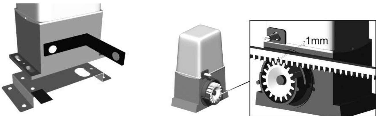
**FISSAGGIO DELLA CREMAGLIERA E DEI FINE CORSA:** Posizionare il primo elemento della cremagliera sulla ruota dentata, in precedenza sbloccata. In seguito fissare l'elemento al cancello, applicando ad esso gli altri elementi della cremagliera necessari, preoccupandosi che tutti siano uniti ed allineati.
