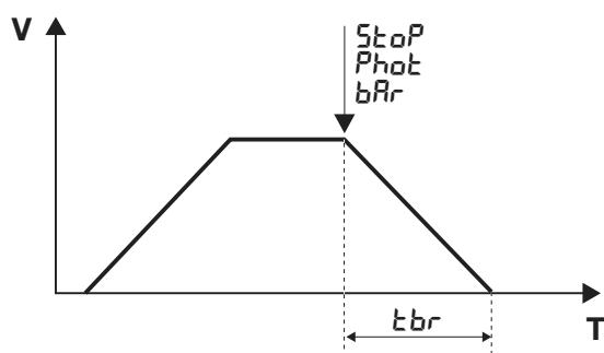
L'intervention de l'entrée de sécurité provoque un ralentissement immédiat de la porte, le temps pendant lequel la porte passe de la vitesse standard à l'arrêt complet est réglable par l'intermédiaire de la valeur TBR et doit respecter les valeurs indiquées dans le tableau 1.
