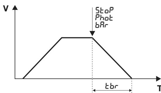
L'intervento dell'ingresso di sicurezza provoca un immediato rallentamento dell'anta, il tempo in cui l'anta passa dalla velocità standard all'arresto completo è regolabile tramite il valore TBR e deve rispettare i valori indicati in Tabella 1.
