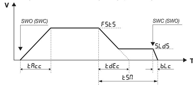
Die V-Achse stellt die Flügelgeschwindigkeit und die T-Achse die Zeit dar, die der Flügel benötigt, um die Strecke zwischen dem einen und anderen Endschalter zurück zu legen. Die Parameter regeln auf dieselbe Weise sowohl das Öffnen als auch das Schließen.
