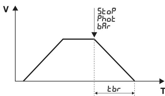
Der Eingriff des Sicherheitseingangs führt zu einer sofortigen Verlangsamung des Flügels. Die Zeit in welcher der Flügel von der Standard-Geschwindigkeit zu dem vollständigen Stop übergeht, kann mit dem Wert TBR eingestellt werden und muss die Angaben in Tabelle 1 berücksichtigen.
