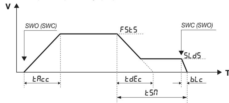
L'axe V représente la vitesse du vantail, l'axe T représente le temps utilisé par le vantail pour parcourir l'espace d'un fin de course à l'autre. Les paramètres règlent indifféremment la phase d'ouverture et la phase de fermeture.
