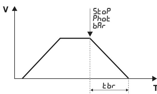
La actuación de la entrada de seguridad produce una ralentización inmediata de la hoja. El tiempo durante el cual la hoja pasa de la velocidad estándar a la parada completa puede regularse mediante el valor TBR y debe respetar los valores indicados en la Tabla 1.
