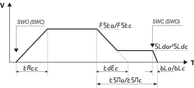
L'asse V rappresenta la velocità dell'anta, l'asse T rappresenta il tempo impiegato dall'anta per percorrere lo spazio da un finecorsa all'altro. I parametri regolano allo stesso modo sia la fase di apertura, sia la fase di chiusura.
