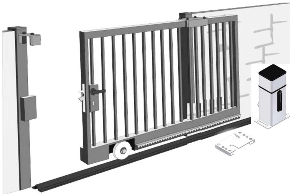
2-. Una vez se ha fijado correctamente la chapa base U al suelo, se deberá de colocar sobre esta el motor, haciendo coincidir los tracolis laterales con los insertos de la chapa.
