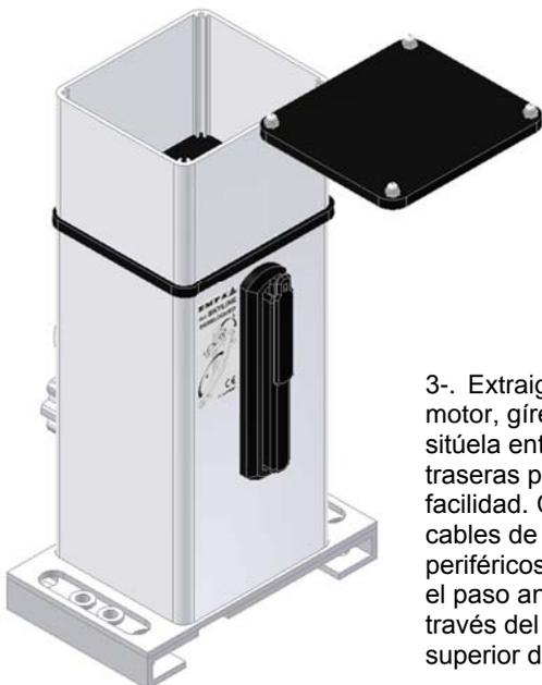
3-. Extraiga la tapa superior del motor, gírela hacia arriba y sitúela entre las 2 varillas traseras para trabajar con mayor facilidad. Compruebe que los cables de alimentación y periféricos que ha introducido en el paso anterior, han llegado a través del tubo a la parte superior del equipo.
