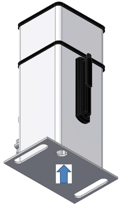
2-. Pase los cables de la corriente (alimentación), periféricos (fotocélulas, bandas, piloto de destellos, etc) por el agujero de debajo del equipo y hágalo llegar hasta la parte superior del motor.
