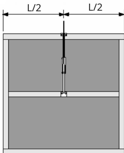
2. Instale el adaptador ARCO007 en el portón: en el centro y verticalmente. La esquina superior del brazo curvo debe quedar al mismo nivel que la esquina superior de la puerta. El adaptador debe montarse de forma estable; utilice refuerzo si es necesario.
