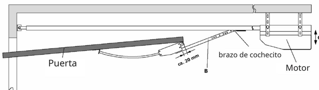
5. Ajuste la posición del motor de acuerdo con las siguientes instrucciones. Con la cancela abierta: el borde inferior de la puerta (D) y la superficie inferior del arco (E) deben estar a la misma altura.
