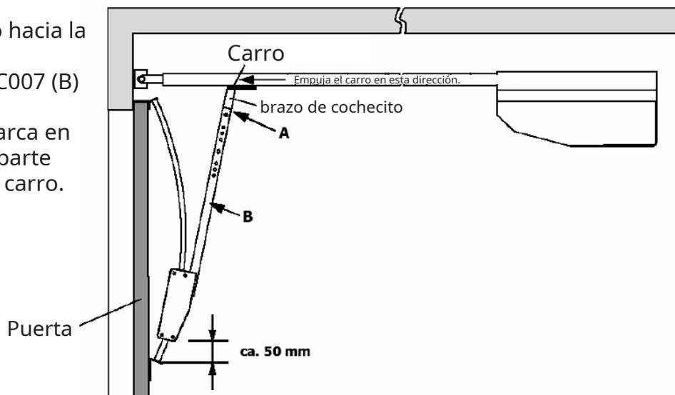
4. Empuje el carro hacia el motor y abra la puerta manualmente. Tirar de la parte móvil del ARC007 (B) hasta aproximadamente 20 mm antes del final del recorrido. Ajustar y fijar la altura del motorreductor (C) de manera que la muesca creada en (A) corresponda al brazo del carro.
